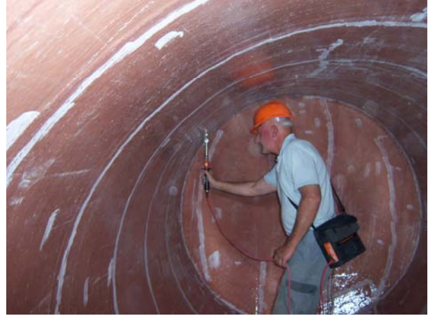
Vérification de l'étanchéité de la stratification au détecteur de porosité, et mesure d'épaisseur du revêtement.
